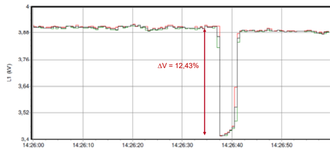
Fig. 7. Medição da Queda de Tensão Obtida Durante a Partida do Motor
