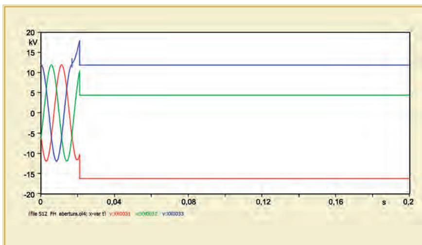
Fig. 7 – Simulação 12: Tensões transitórias durante o desligamento do banco de capacitor BC-02
