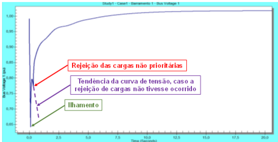
Figura 4 – Tensão na Barra 1 de 20,5 kV na 2ª Simulação
